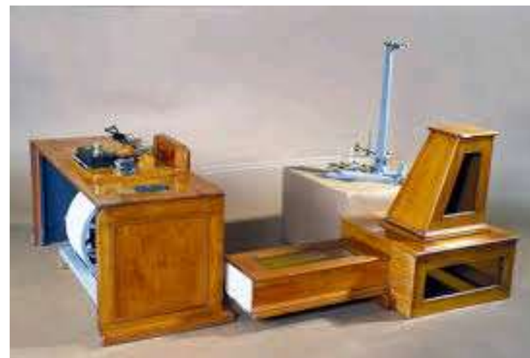
Milne Double Boom Seismograph, 1908. Maker: R. W. Munro.
